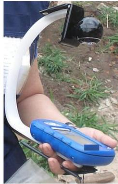
**Figura 1. Artefato acoplado ao PDA com *webcam***
